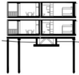
Assemblaggio dell'edificio Moduli prefabbricati - muri e solai in legno GLC - travi in legno CLT - facciata in legno di quercia
