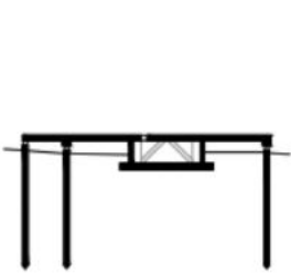
Costruzione delle fondazioni Fonazioni in legno - pali in larice - cavedio tecnico - griglia di distribuzione
